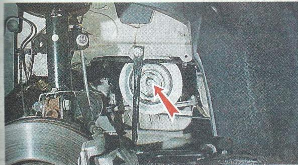
Для этого потребуется снять грязезащитный щиток моторного отсека под правым передним крылом.
