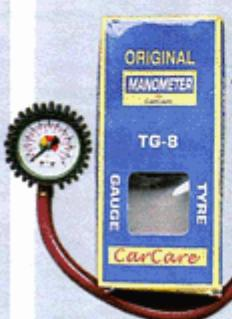
Еще один «итальянский профессиональный» манометр откровенно разочаровал. Для замера давления его нужно сильно прижимать к штуцеру колеса, при этом успевать считывать показания, поскольку, как только контакт ослабнет, стрелка сбросится на «ноль». Как оказалось, шланг на морозе быстро «дубеет». Хорошо еще, погрешность при замерах до 3,5 бар составляет всего 0,05 бар.
