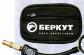
«Беркутовский» манометр оказался не самым дорогим, зато самым удобным, функциональным и достаточно точным (погрешность и разброс измерений не превысили 0,05 кгс/см<sup>2</sup>). Прибор оснащен навинчивающимся на штуцер колеса наконечником и очень практичным приспособлением для стравливания лишнего воздуха при подключенном манометре. Продается в комплекте с сумочкой для хранения.
