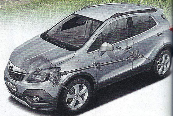
▲ Полноприводная трансмиссия: задняя ось подключается автоматически через муфту Haldex III поколения
