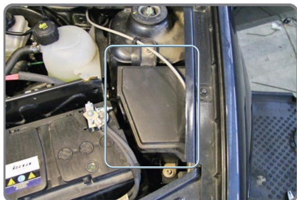
Фото 18.1. Блок реле и предохранителей
