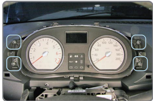
Фото 2.2. Крепление приборного щитка
