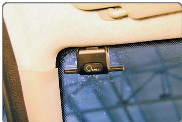
Фото 5.3. Антенный модуль на лобовом стекле
