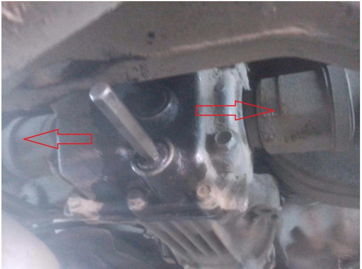
5. У муфты и редуктора есть по 1(одному) сапуну (всего два сапуна) в верхней их части, их отсоединяем сразу, чтобы они потом не мешались.
