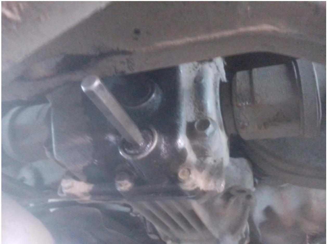
б) дожидаемся когда все сольется и откручиваем заливную (верхнюю пробку) для более тщательного слива масла из редуктора.
