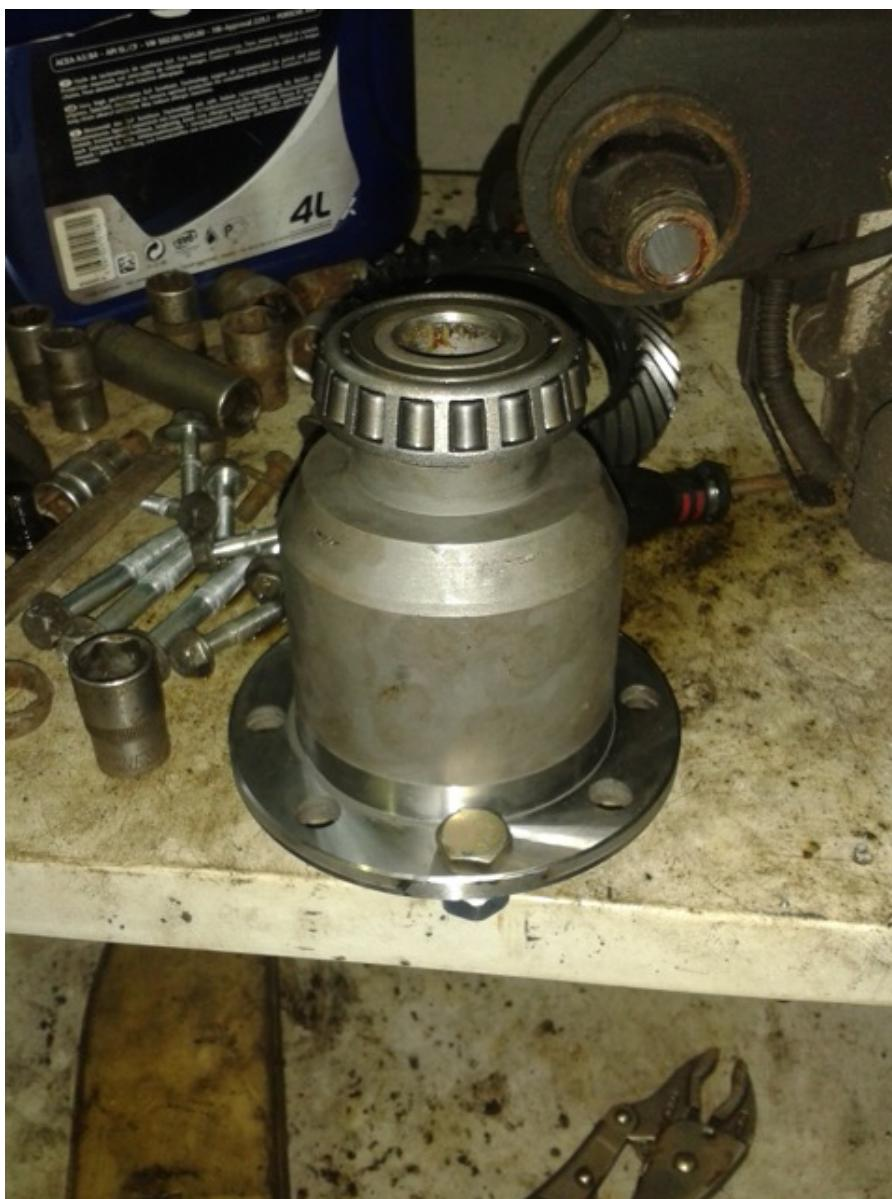
**если Ваш самоблок БОЛЬШЕ или равен штатному дифференциалу**, так же запрессовываем снятые подшипники на самоблок.
