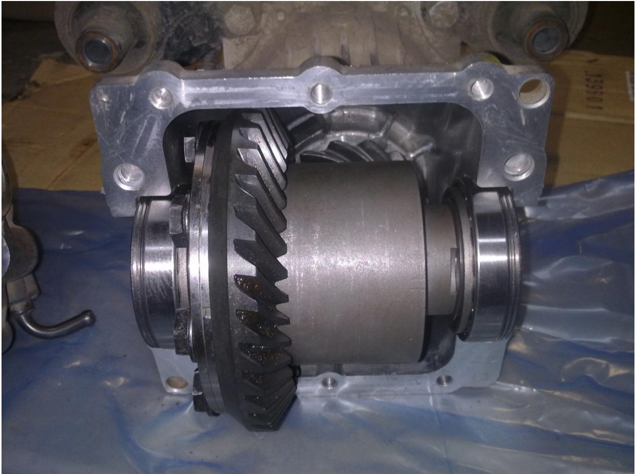
слева и справа устанавливаем снятые ранее штатные (большие) шайбы!
