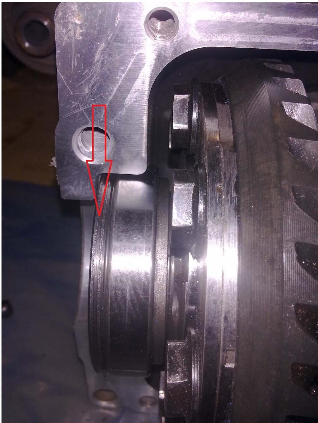
19. Смазываем новым герметиком крышку (вместо прокладки).
