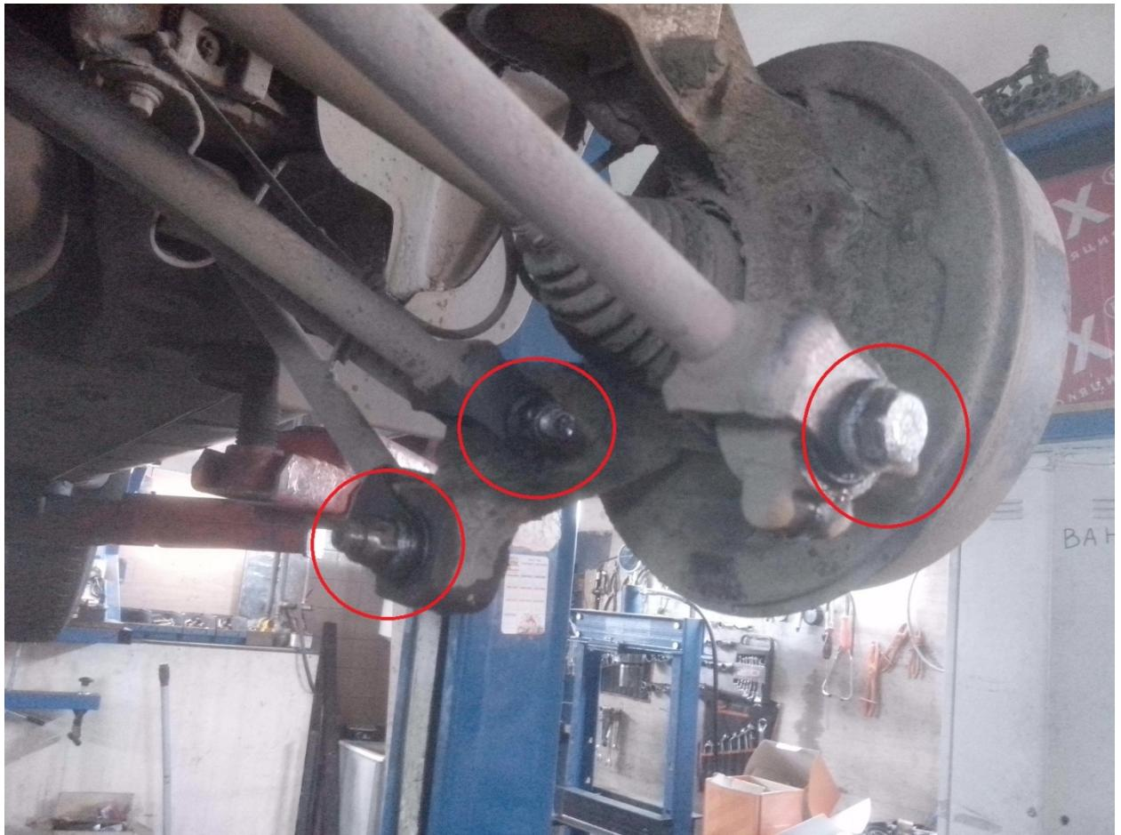
Гайки на стойке амортизаторов не трогаем!
