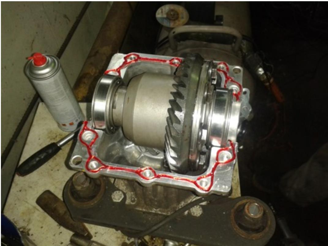
20. Ставим крышку дифференциала обратно и закручиваем все болты.
