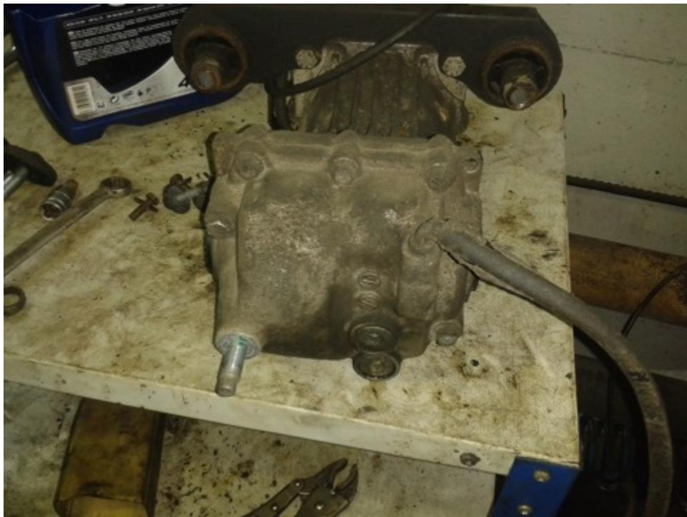
9. Откручиваем крышку дифференциала (болты по периметру )
