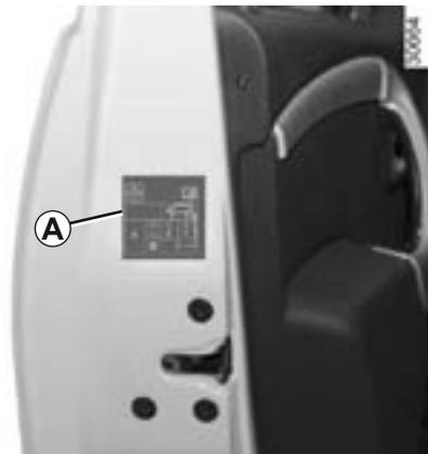
Давление воздуха в шинах соответствует указанному на этикетке **A**, расположенной на торце двери водителя. Чтобы прочитать ее, откройте дверь.
