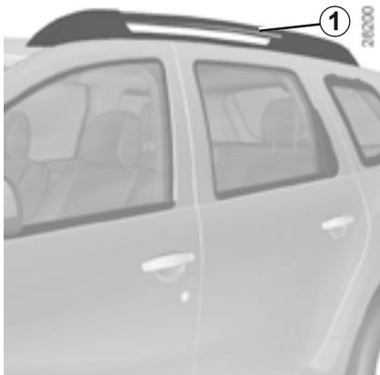
Когда они установлены на автомобиле, Вы можете перевозить багаж или дополнительные принадлежности (держатель для велосипедов, держатели лыж и т. п.) на багажнике крыши или на поперечинах, закрепляемых на продольных направляющих **1**, или непосредственно на них самих.
