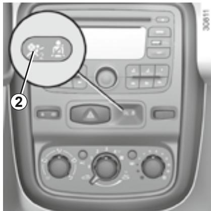
Для выключения подушки безопасности переднего пассажира на стоящем автомобиле и при выключенном зажигании нажмите и поверните переключатель **1** в положение OFF.
