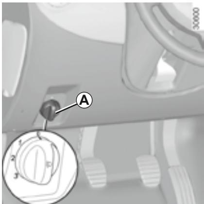
Ручка **A** служит для регулировки света фар в вертикальной плоскости в зависимости от загрузки автомобиля.
