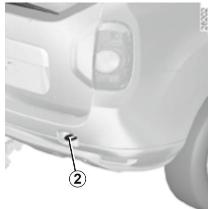
Буксировочные проушины предназначены только для буксировки; ни в коем случае не используйте их прямым или косвенным образом для подъема автомобиля.
