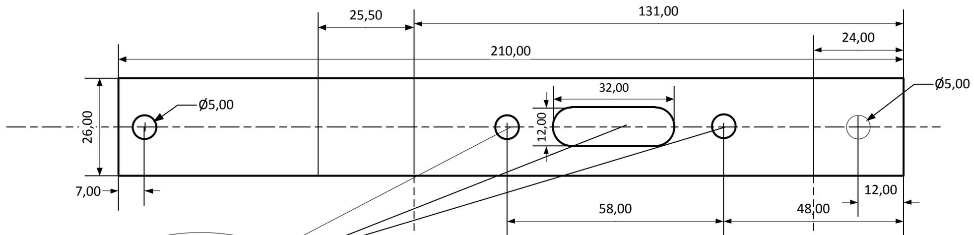
Эти отверстия переносятся с штатной скобы Филипса (она потом сюда и крепится). диаметр крепёжных отв. выбирается по саморезу
