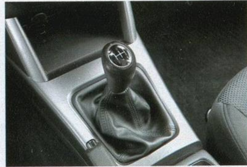
Рычагу недостает четкости переключений — при переходе со второй на третью передачу часто попадаешь в «перемычку» между третьей и пятой
