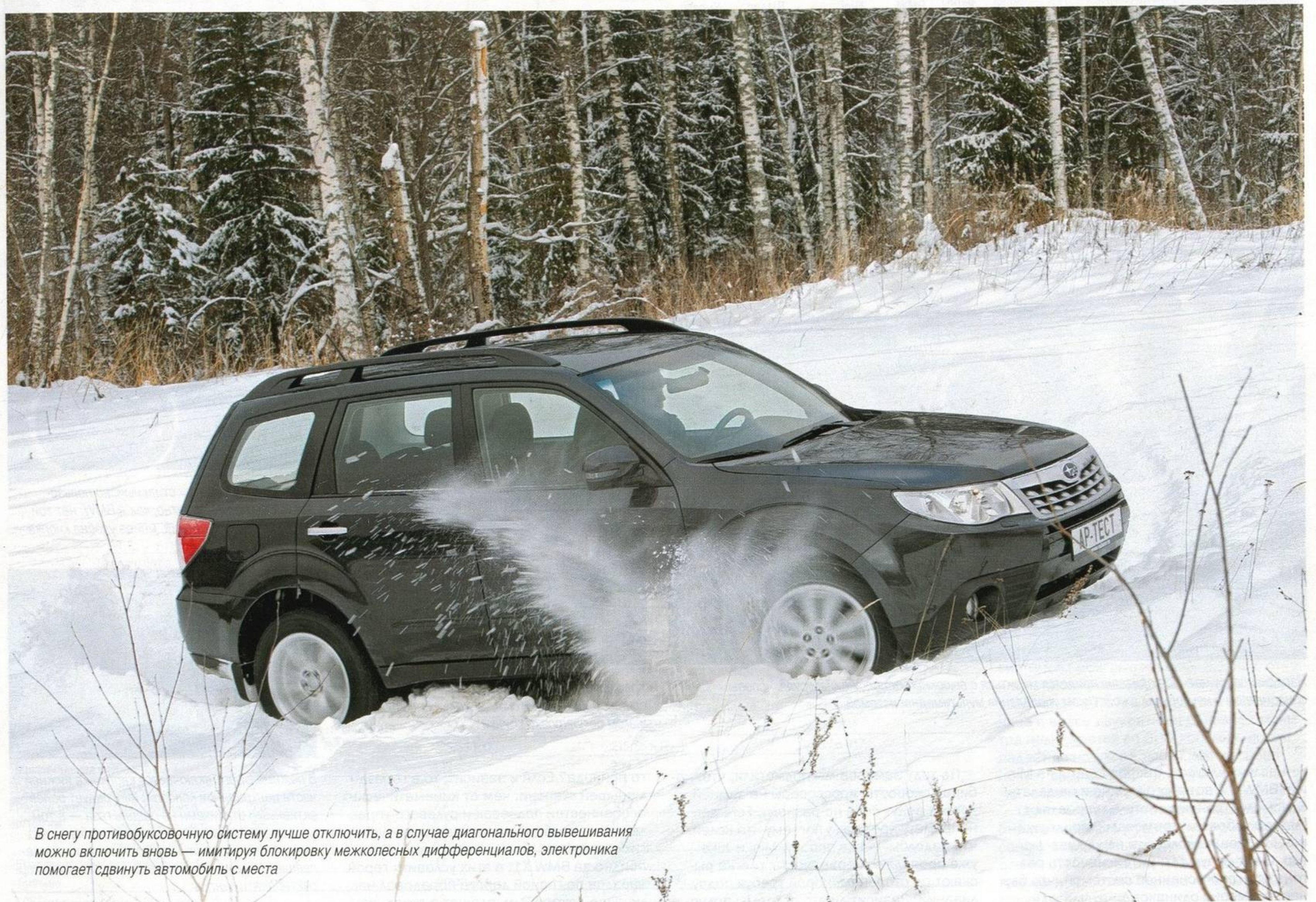
Понижающая передача с отношением 1,45:1 — слабое подспорье на бездорожье. На малых оборотах мотору не хватает момента: он норовит заглохнуть даже с включенным демальтификатором
