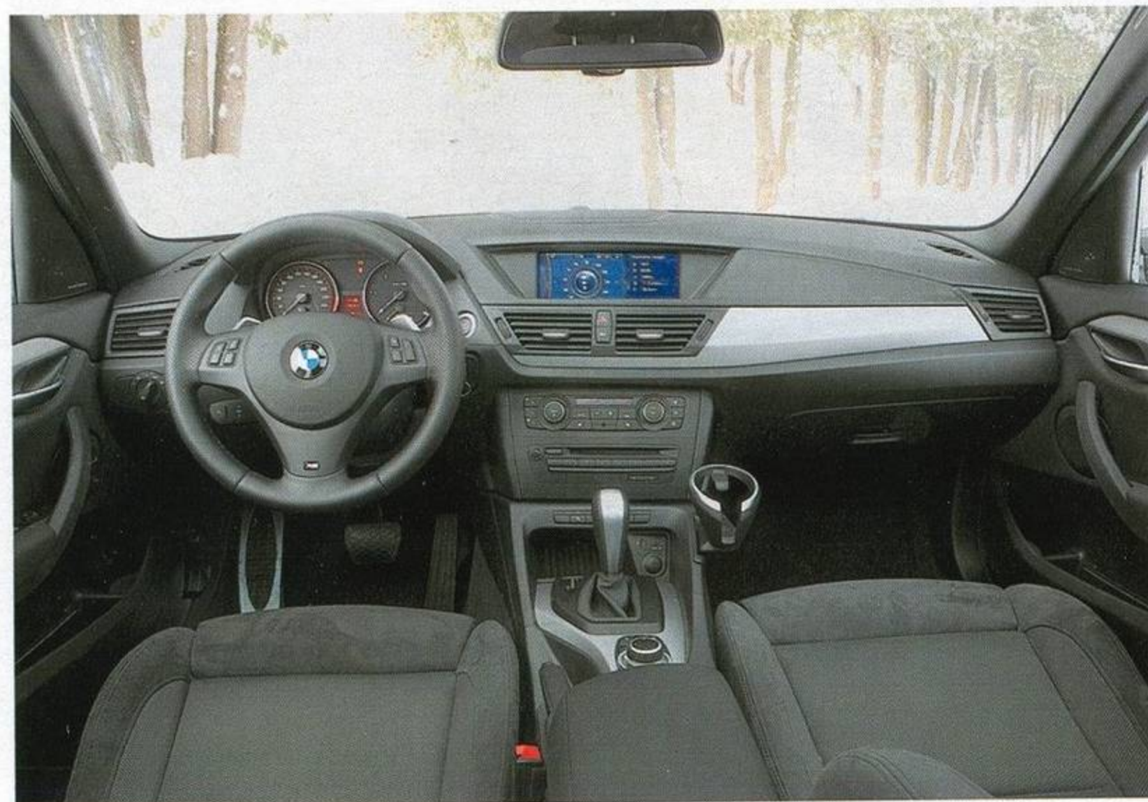
Идеальную эргономику BMW портит разве что отсутствие фиксируемых рабочих положений у подрулевых переключателей
