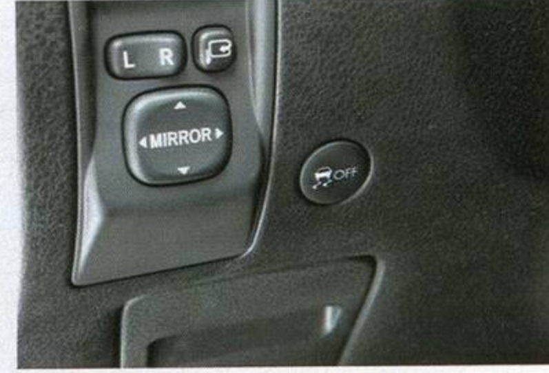
Кнопка слева от руля делает Off только противобуксовочной системе
