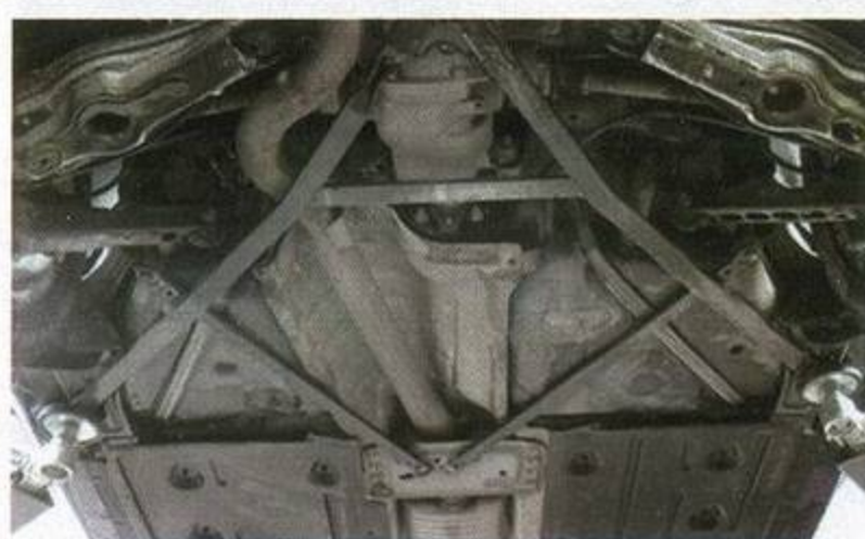
Под задней частью днища BMW мы обнаружили конструкцию растяжек — вместе со спортивной подвеской они входят в M-пакет. На стандартных BMW X1 таких усилителей нет
