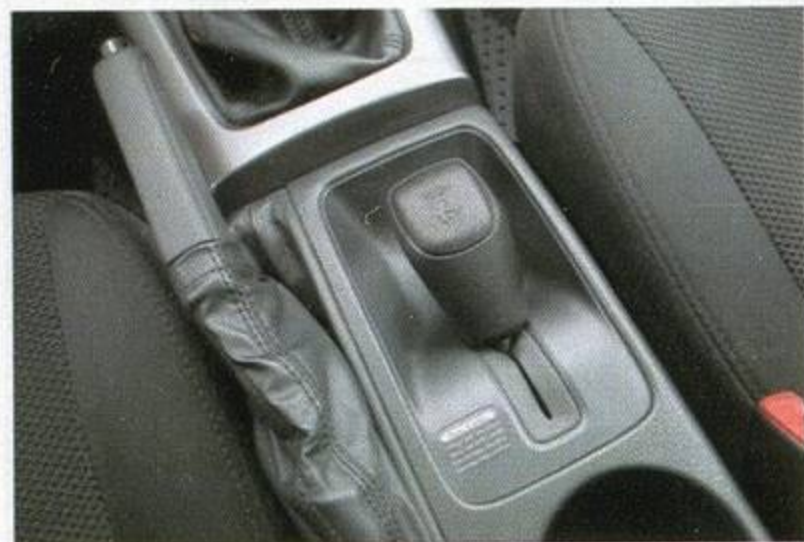
Понижающая передача с отношением 1,45:1 — слабое подспорье на бездорожье. На малых оборотах мотору не хватает момента: он норовит заглохнуть даже с включенным демальтификатором
