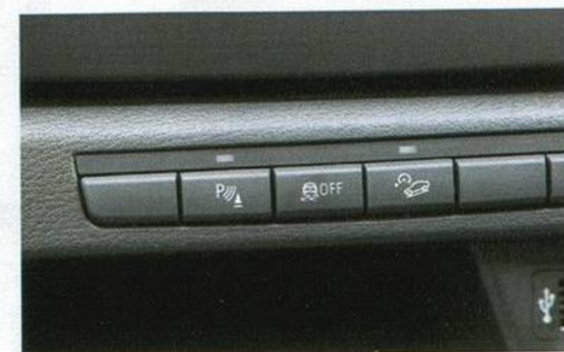
Средняя кнопка последовательно отключает traction control и систему стабилизации. Из внедорожных режимов — лишь контроль скорости спуска с горы (активируется правой кнопкой)
