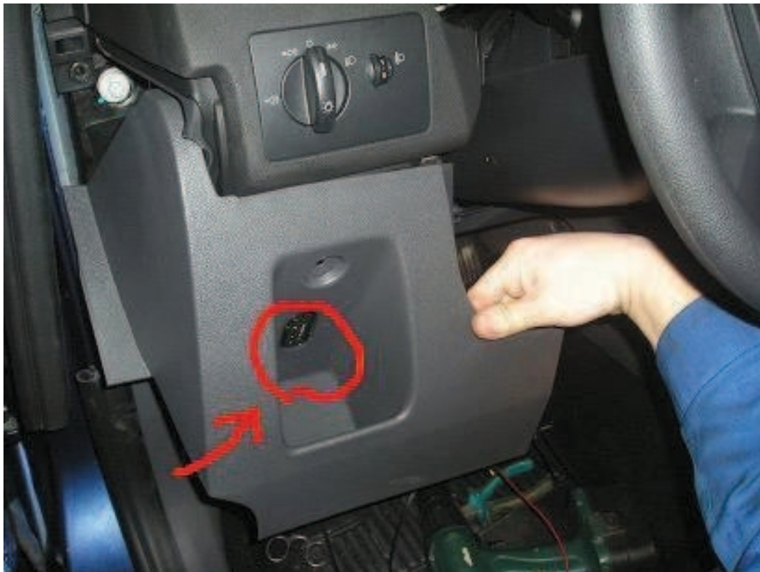
Расположение диагностического разъема в автомобиле Ford Focus 2
