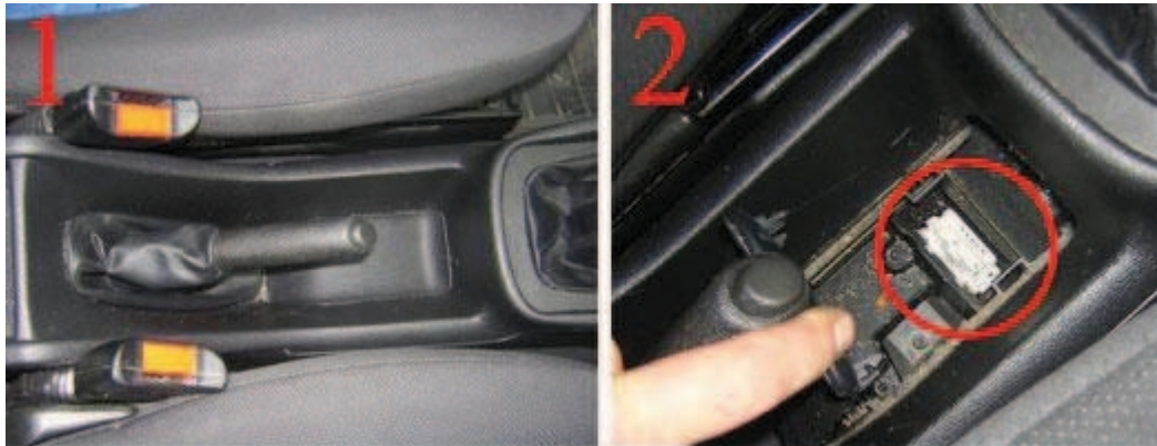
Расположение диагностического разъема в автомобиле Opel Zafira
