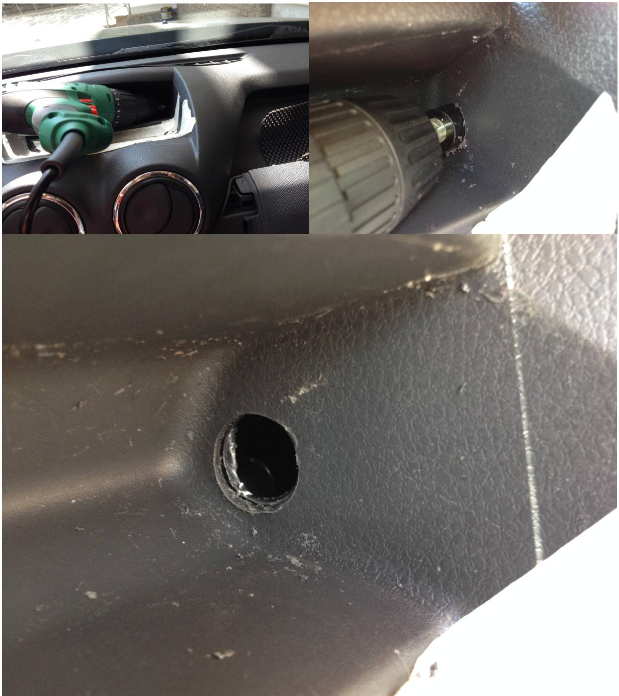
Рисунок 4 - Отверстие под кабели.
