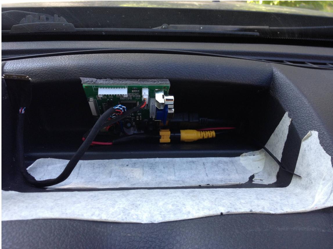
Рисунок 6 - Правильное положение приклеенного контроллера монитора
