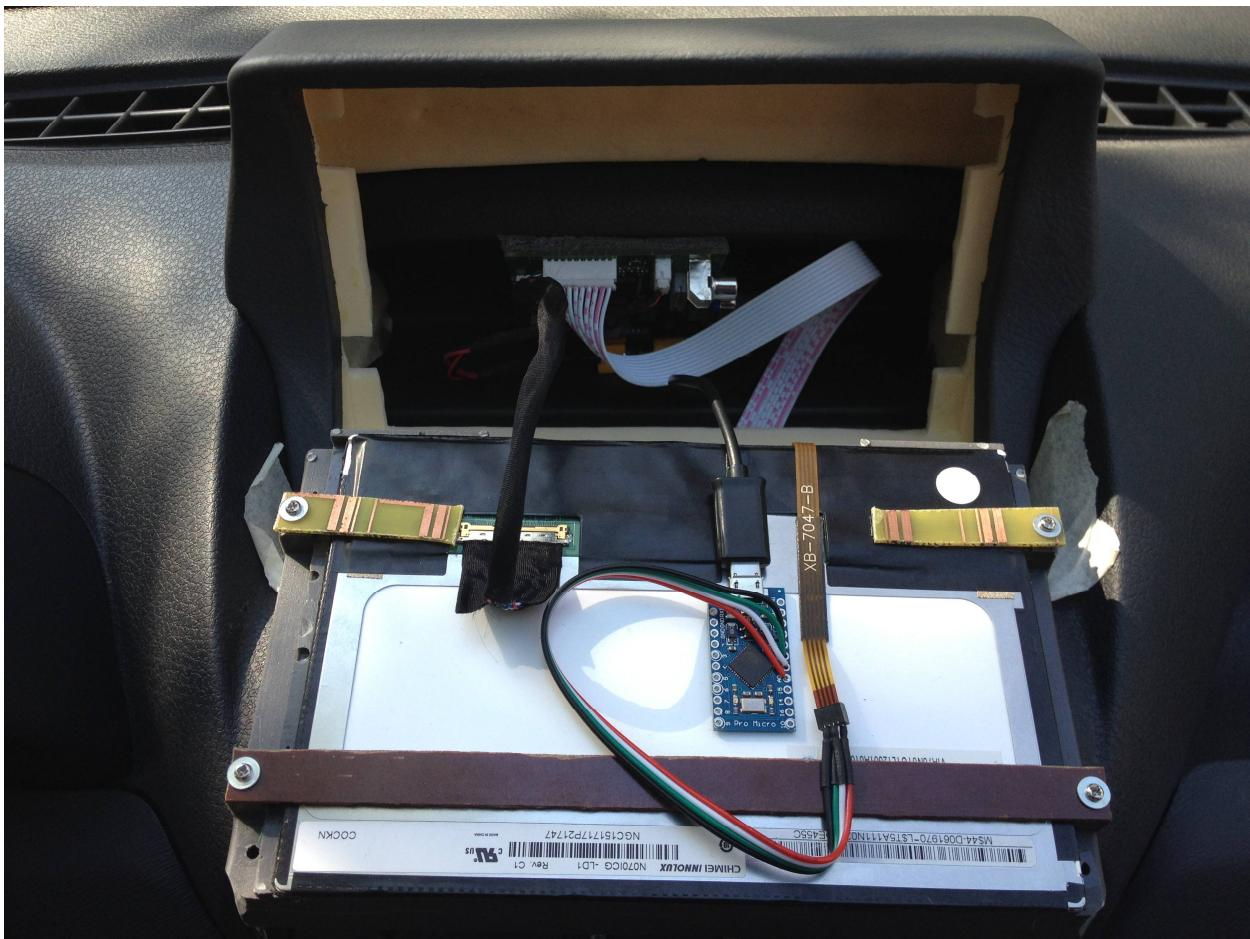
Рисунок 10 - Подключение кабелей монитора и сенсора
