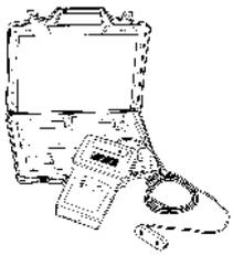
16163  | Mot. 1505      | 00 00 150 500   | Прибор для проверки натяжения ремней                                           |
