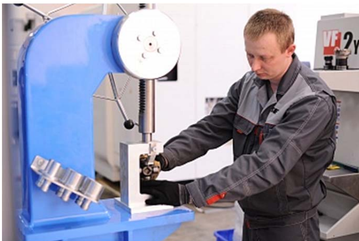
Пресс для запрессовки, выпрессовки и кернения крестовин карданных валов
