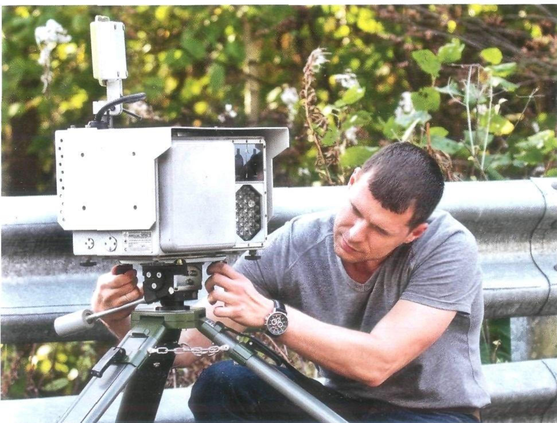
Радар Крис-П мы установили так, как это делают хитрые охотники: под углом к проезжей части и с небольшим наклоном вниз. И проверили разницу в дальности детектирования при полном отсутствии помех и трафика
