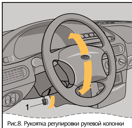
Рис.8. Рукоятка регулировки рулевой колонки
