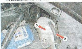
О неисправности обратного клапана можно судить по сжимающимся шлангам системы охлаждения при остыании двигателя.
