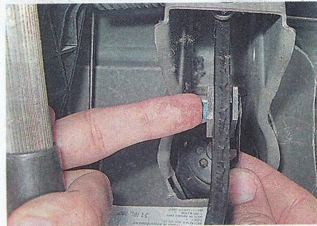
...извлекаем палец вилки вакуумного усилителя тормозов.
