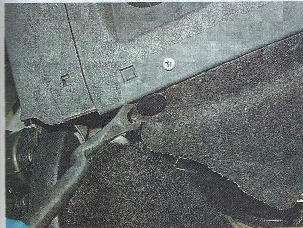
6. Поддев шлицевой отверткой, снимаем две прижимные шайбы крепления шумоизоляционного щитка.
