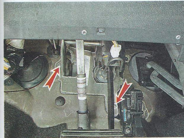
7. Снимаем шумоизоляционный щиток.
