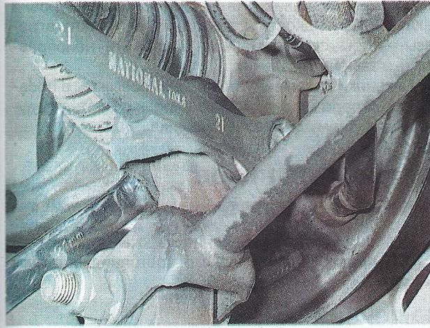
6. Извлекаем болты крепления и снимаем рычаг.
