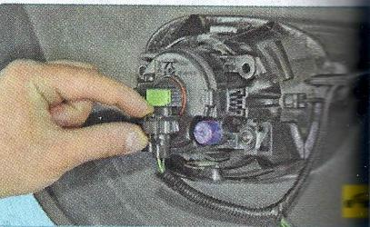
2. Отожмите фиксатор крепления колодки жгута проводов...
