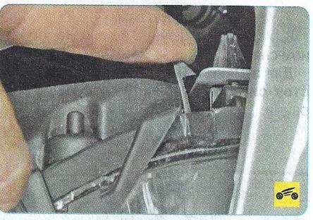
8. Отожмите фиксатор крепления блок-фары к кронштейну на кузове...
