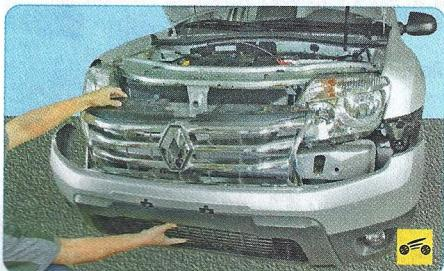
2. Снимите передний бампер (см. «Снятие и установка переднего бампера», с. 247).
