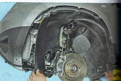
1. Снимите подкрылок переднего колеса (см. «Снятие и установка подкрылок и брызговиков колес», с. 250).
