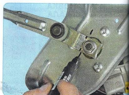
2. Пометьте положение кривошипа относительно кронштейна.
