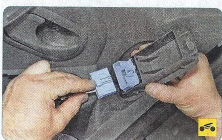
4. Отожмите фиксаторы колодки жгута проводов блока управления стеклоподъемниками и отсоедините колодку.
