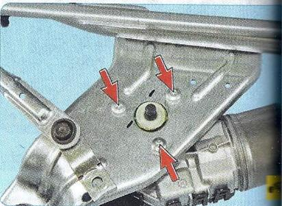
5. Выверните три болта крепления моторедуктора к кронштейну...
