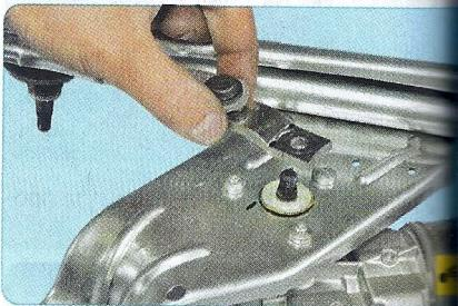
4. Снимите кривошток со шлицев вала.
