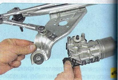
6. ...и снимите моторедуктор.
