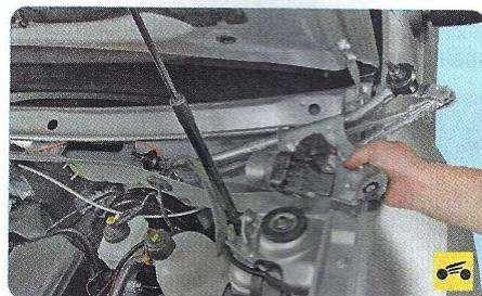
1. Снимите трапецию стеклоочистителя в сборе с моторедуктором (см. «Снятие и установка трапеции стеклоочистителя ветрового окна», с. 254).
