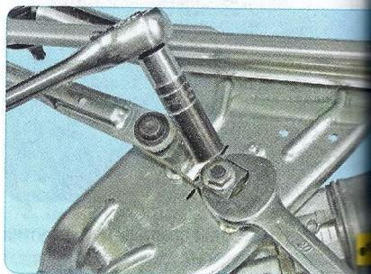
3. Отверните гайку крепления кривошипа для снижения нагрузки на зубья пластика шестерни редуктора. Удерживайте кривошток от проворачивания рожковым ключом.
