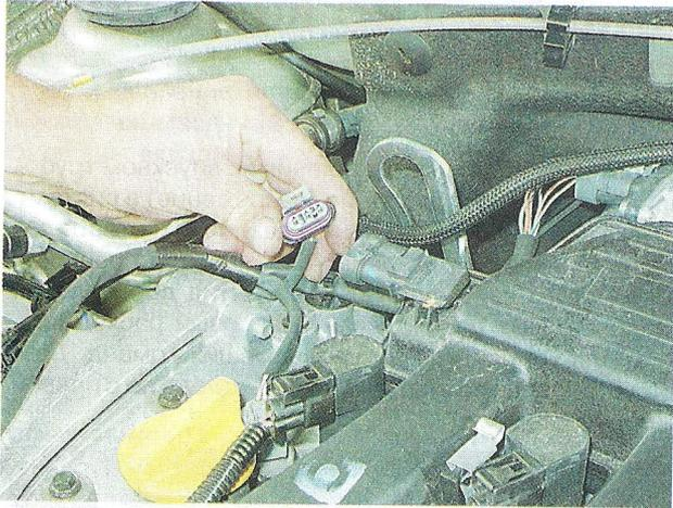
4. Осматриваем разъем и убеждаемся в отсутствии на его выводах повреждений и окислов. При необходимости обрабатываем выводы специальным средством для очистки и защиты электрических контактов.
