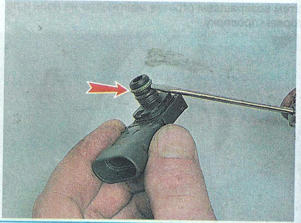
8. Наносим на уплотнительное кольцо тонкий слой моторного масла и устанавливаем датчик во впускной трубопровод.
